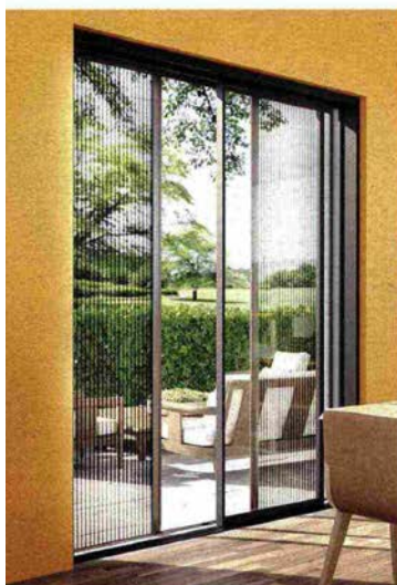
↑ Minimo ingombro per il tipo plissettato Micro 13mm del Gruppo Genius ( www.geniusgroup.it ), che ha profili laterali di spessore 13 mm. In versione con scorrimento orizzontale l'anta è singola o doppia , con larghezza massima di 360 cm; se verticale misura L 30-160 cm.
